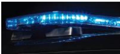
**REFLECTOR LED SOLARIS** Fabricada con la tecnología de reflector LED Solaris, la barra de luces Allegiant está diseñada para aumentar en gran medida la advertencia fuera del eje y maximizar la fuente de luces LED para eliminar los puntos oscuros y aumentar la visibilidad en la carretera.
