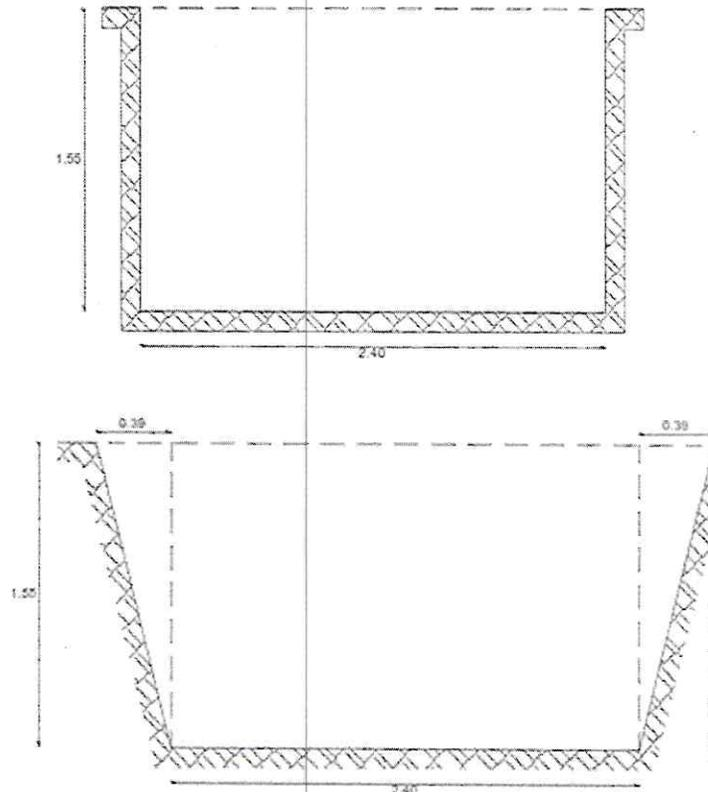
Proceso para el mejoramiento de suelo para recibir cemento para poste de 17.00 de altura mediante la colocación de capa de tepetate compactado al 90% Proctor, o mediante grava controlada de ¾" 70-30 compactada al 90% Proctor.
